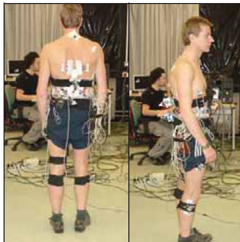
Afb. 7. De proefpersoon geheel beplakt met elektroden en elektrogoniometers.
